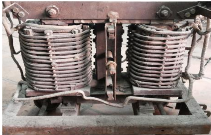
Hình 2.3.1: Phương pháp di chuyển lõi thép từ của máy hàn 1HX230
