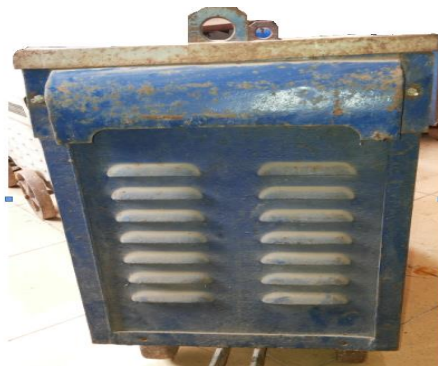
Hình 2.1.2: Mặt trước máy hàn 1HX230
