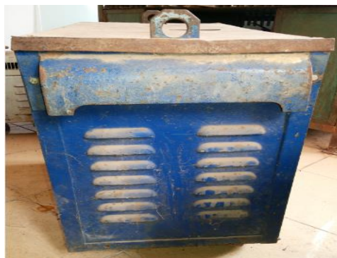
Hình 2.1.3: Mặt sau máy hàn 1HX230
