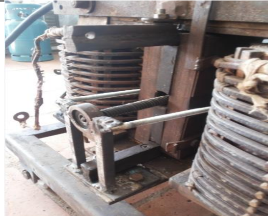
Hình 2.4.2: Hệ thống di chuyển lõi thép di động máy hàn AC200 mới
