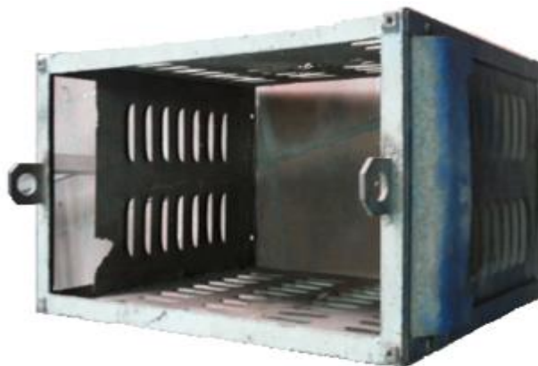
Hình 3.1.1: Hệ thống làm mát của máy hàn 1HX230
