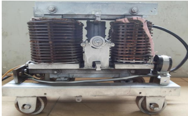
Hình 2.2.3 : Kết cấu bên trong của máy hàn
