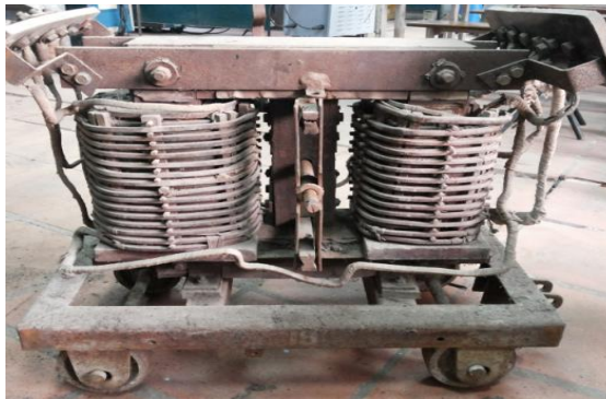
Hình 2.1.11: Hệ thống di chuyển lõi thép di động máy hàn 1HX230
