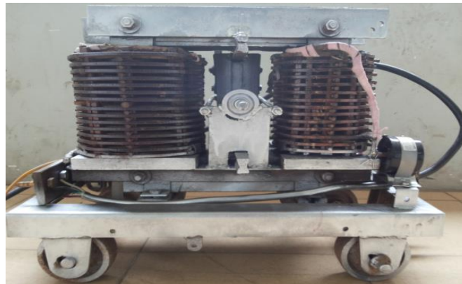
Hình 2.2.3 : Kết cấu bên trong của máy hàn
