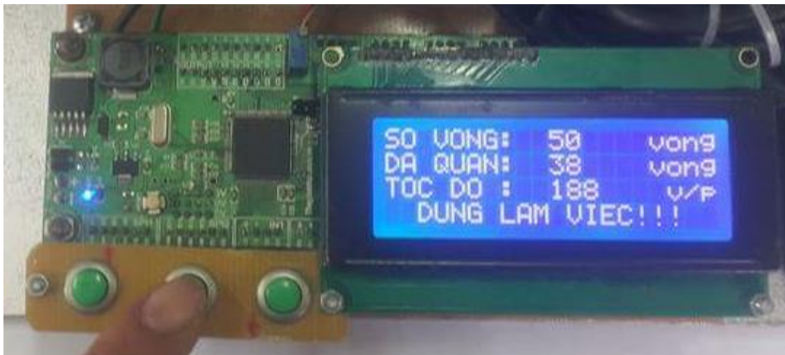
Hình 3.7 Màn hình hiển thị thông báo hệ thống đang tạm dừng
