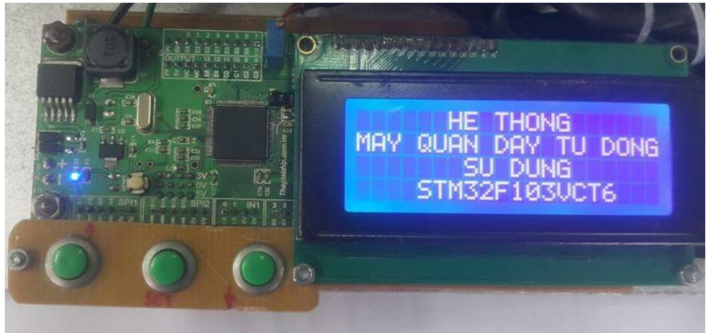
Hình 3.2 Màn hình LCD báo hệ thống điều khiển bắt đầu làm việc
