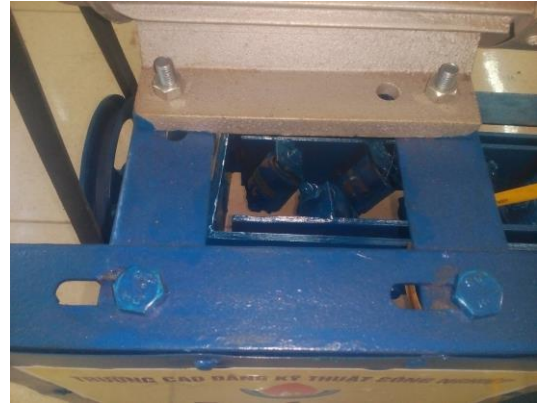
Hình 7. Bộ phận động cơ sử dụng trong máy nắn thép
