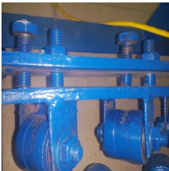
Hình 4. Điều chỉnh khoảng cách giữa 2 hàng con lăn
