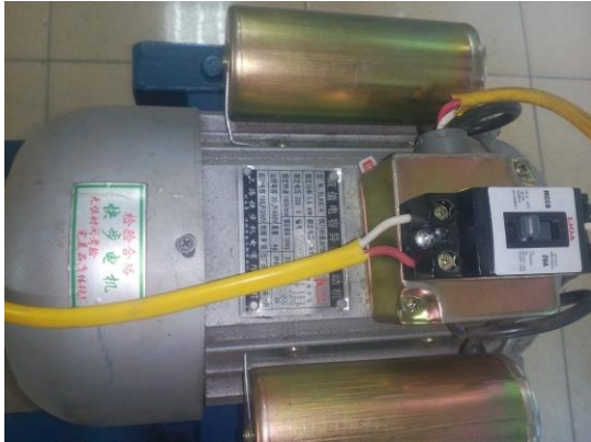
Hình 7. Bộ phận động cơ sử dụng trong máy nắn thép
