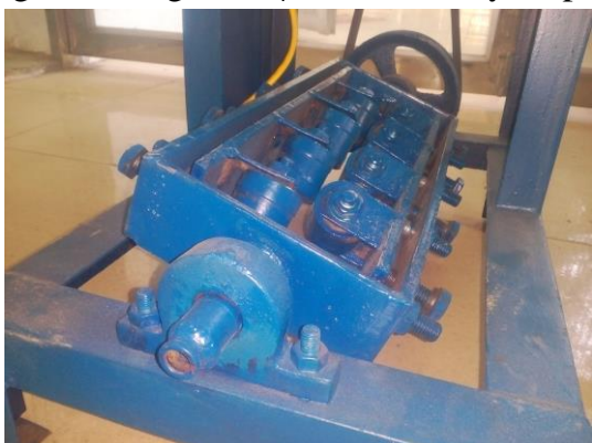
Hình 5. Hai đầu trục của bộ duỗi thép có gia công lỗ \phi 12
