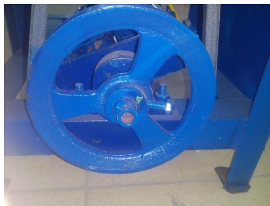
Hình 5. Hai đầu trục của bộ duỗi thép có gia công lỗ \phi 12
